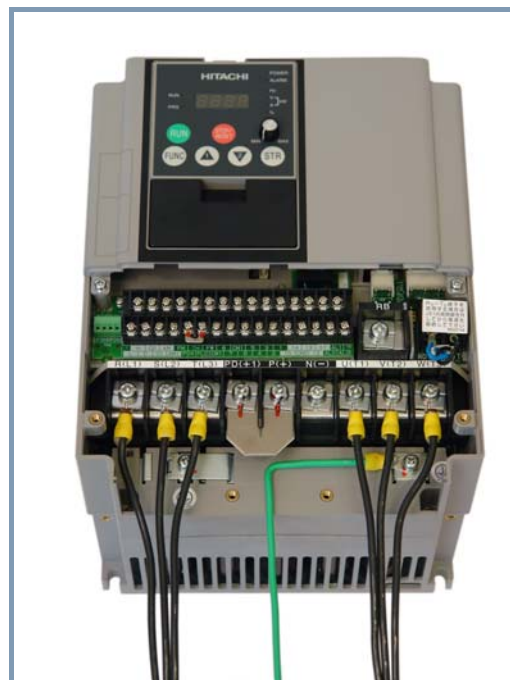
K napájecí síti ke kostře rozvaděče K motoru
