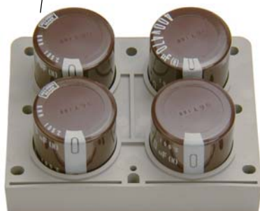
Blok kondenzátorů DC meziobvodu (viz "Výměna kondenzátorů" na str. 6–17)
