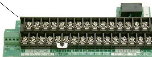
Svorkovnice řídicích signálů (viz "Příklady zapojení vstupů" na str. 4–12)
